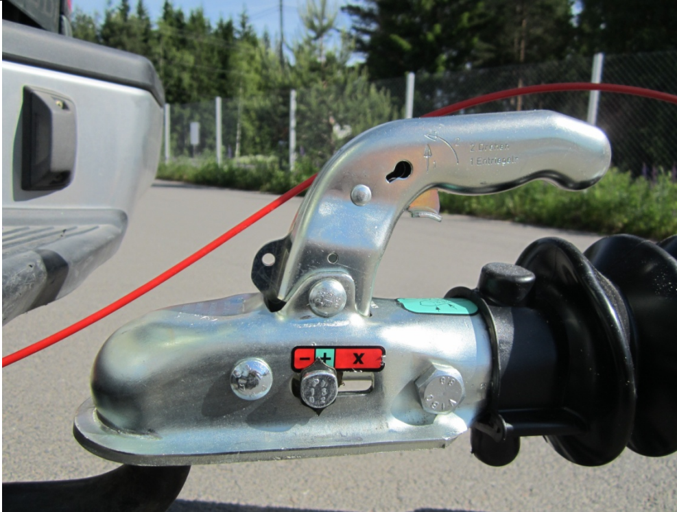
Kuva 1: Kuulakytkimen ollessa lukittuna vetokuulaan tulee lukituksen tarkastusilmaisimen osoittimen olla vihreällä merkityllä + / OK -alueella.
