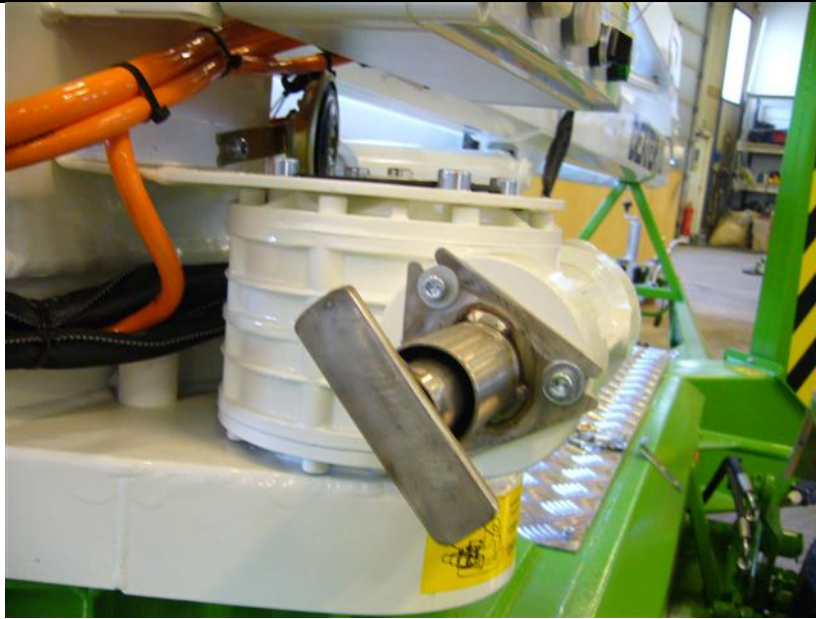
Kuva 10: Pyöryksen varakäytön työkalu asetettuna pyöritystä varten.
