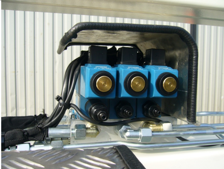
Kuva 2: Paineenrajoitusventtiili alapuomin päällä olevassa venttiiliyksikössä.
