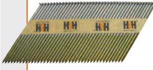
Teknisistä toiminnallisista syistä 34° paperi/teippasidotti asetetaan peräkkäin ja niissä on yleensä D-muotoinen kanta. Nykyään on olemassa myös pyöreäpäisiä 34 asteen nauloa, näissä kanta asetetaan "offset" seuraavan kannan alapuolelle. Paperasidottuissa (34°) on enemmän nauloa, koska ne kootaan ilman rakoja. Vastaavissa naulaimissa on siten usein lyhyemmät lippaat, joita monet pitävät tasapainoisempina. Herkempi kosteudelle, lämpötila ei vaikuta paperiliimattuihin nauhoihin.
